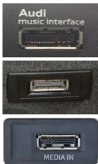
Port Media Interface (Audi, Mercedes, VW, Skoda...) tune2air WMA-3000-A
