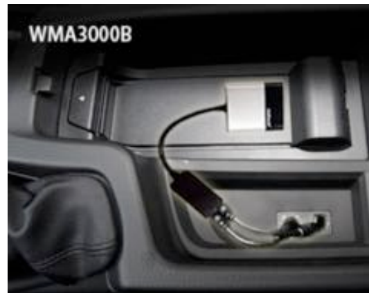
Installation sur port USB/AUX-in (BMW) tune2air WMA-3000-B
