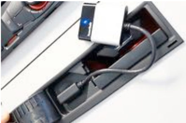
Installation sur port Media Interface (Audi) tune2air WMA-3000-A
